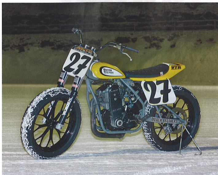
Klassischer Flattrack-Töff mit kurzem Radstand und tiefem Schwerpunkt.
