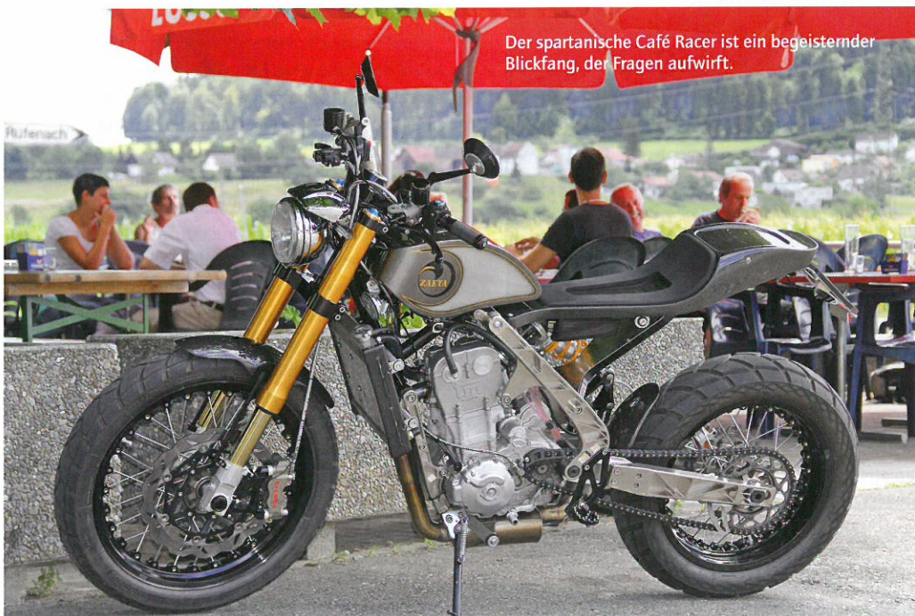
Frästeile, wohin das Auge blickt. Gussformen sind für eine Kleinserie auch ganz einfach zu teuer.
