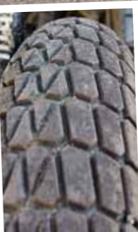
Speciální flattrackové pneumatiky se někdy prořezávají pro lepší grip
