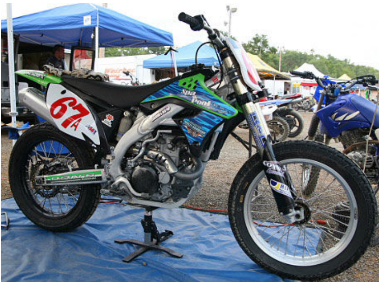
Typische Flat Track Single Maschine basierend auf dem Motocross Modell, hier Kawasaki KX450F (Foto: UM)
